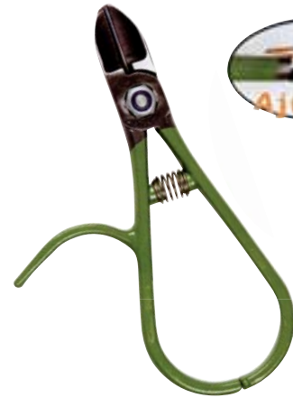
ALICATE CORTANARANJAS M-05 DI AJUSTABLE Alicate profesional, armazon en acero especial ligero y ergonomico, hoja de corte en acero al carbono, templada y afilado especial para una mayor durabilidad y corte más fino. Tornillo y tuerca autoblocante, ajustado fácil y con precisión, la holgura de la hoja y la contra-hoja
